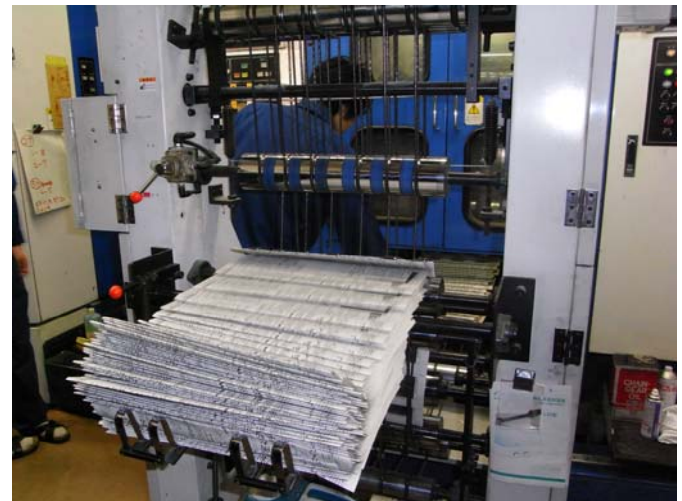
印刷済のロール紙が二つ折りになって出て来るところ
