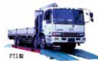
走行計量式簡易トラックスケール
